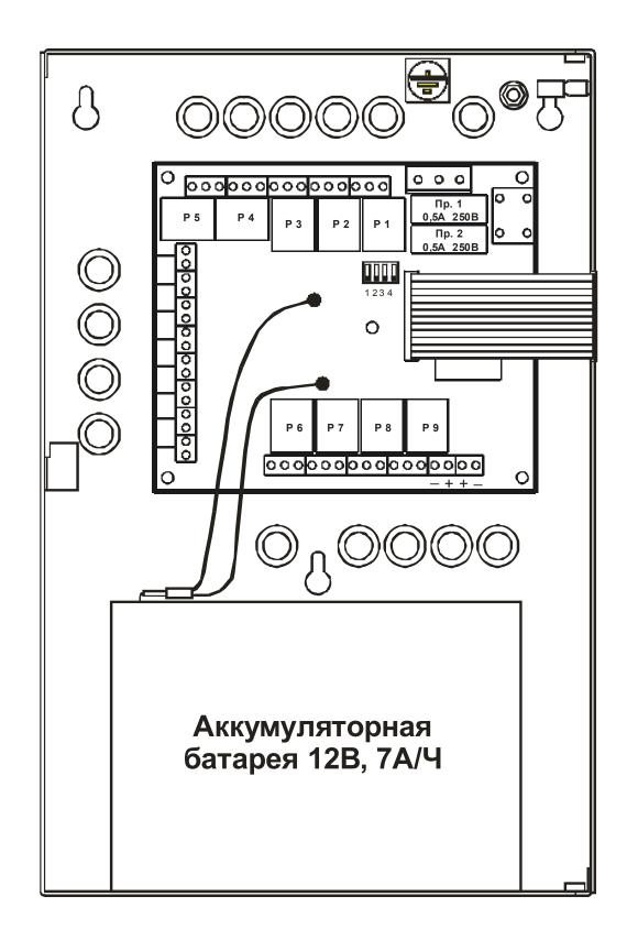
Размещение узлов в корпусе ППКП "ГАММА-108"
