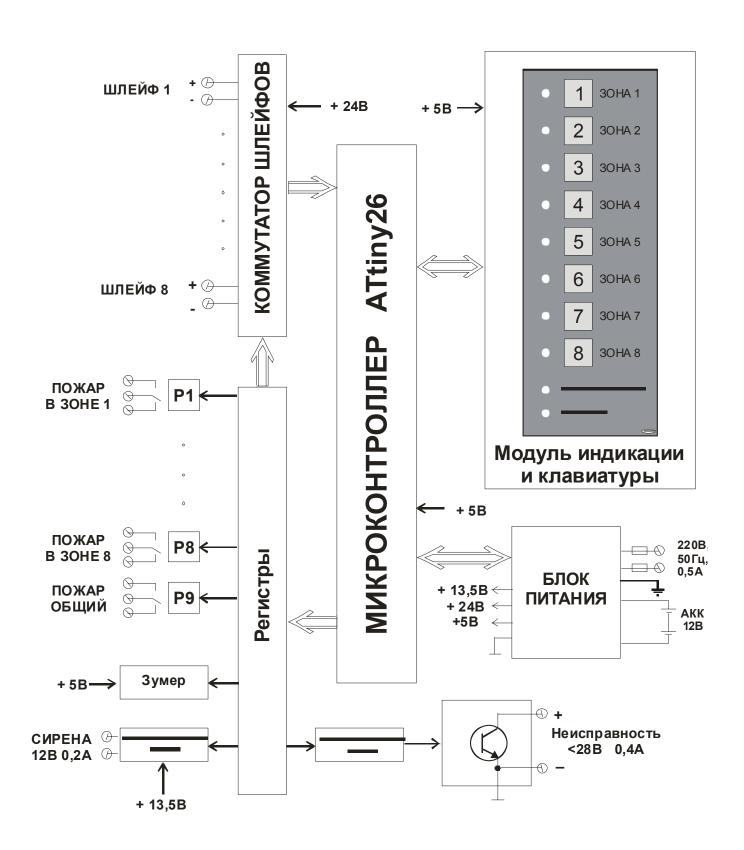
Схема электрическая функциональная ППКП "ГАММА-108"
