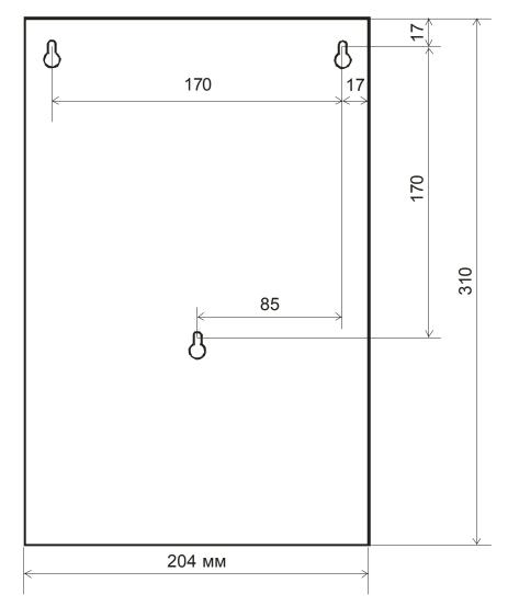
Рис.1 Разметка крепления прибора
